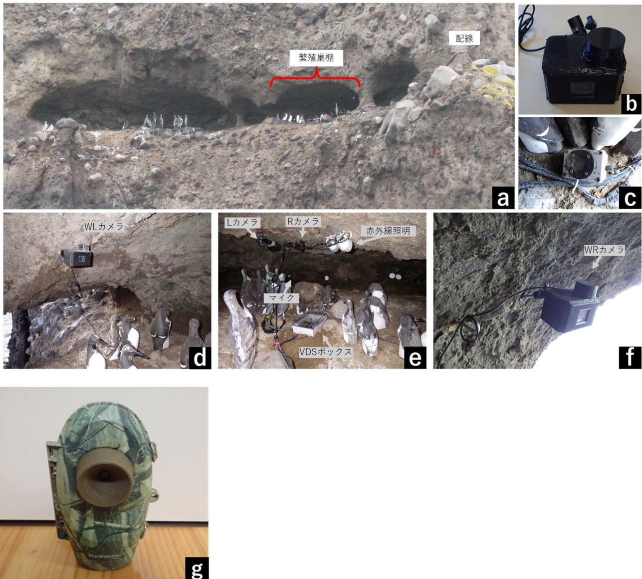
図 3. (a) 赤岩対崖のウミガラスの繁殖巣棚，(b) 繁殖巣棚内に設置したフィルム巻き取り式防汚装置付き CCD カメラ，(c) 繁殖巣棚内に設置した小型スピーカー，(d) 入口側からみて繁殖巣棚の左部分（WL カメラは広範囲を撮影できるように設置），(e) 繁殖巣棚の中央部分（左から L カメラ，R カメラ，マイクはデコイの嘴部分に装着，繁殖巣棚の天井に赤外線照明を設置），(f) 繁殖巣棚の右部分（WR カメラは広範囲を撮影できるように設置），(g) 繁殖巣棚内に設置したインターバルカメラ．
